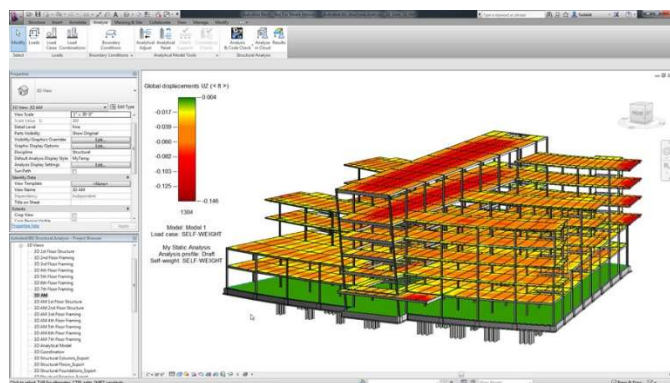
Рис. 2. Пример совместной работы. Расчет нагрузок на здание в программе Revit
