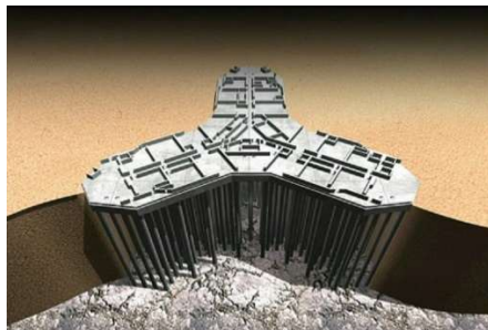
Рис. 4. Коробчатый фундамент башни «Бурдж Халифа»
