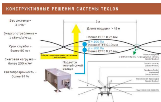
Рис. 5. Конструкция и свойства мембранных подушек ETFE
