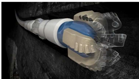
Рис. 2. Устройство для увеличения размера тоннеля
